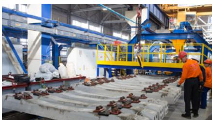
«БЕТЭЛТРАНС» ПРОИЗВОДИТЕЛЬ Ж/Б ШПАЛ ДЛЯ РЖД
